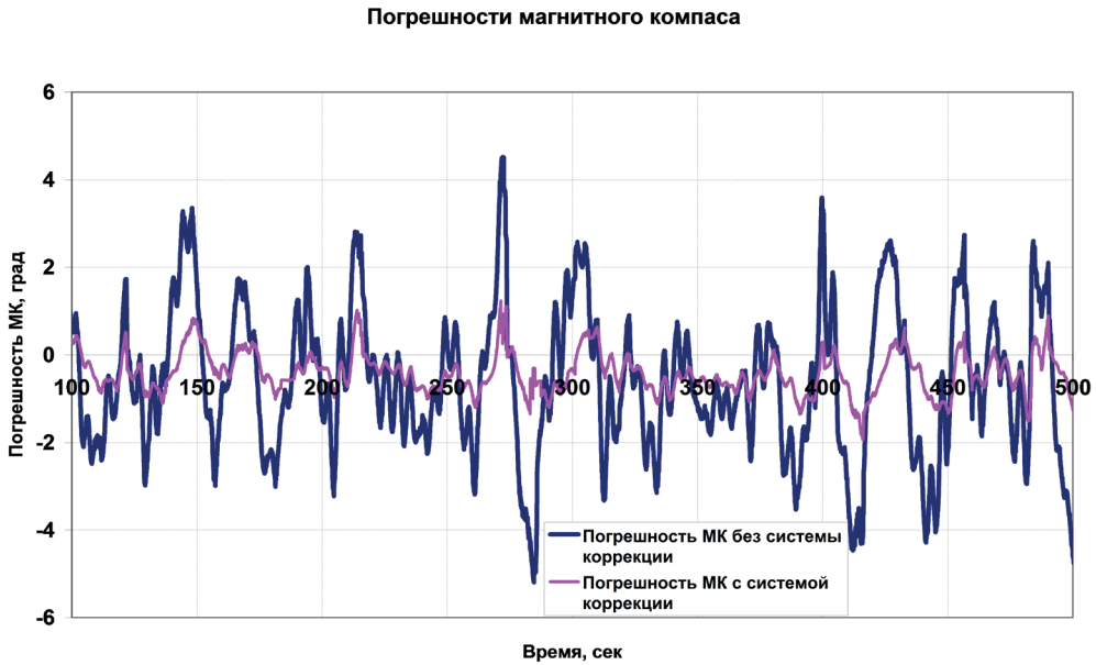
Рис. 11. Погрешности МК с работающей и отключенной системой коррекции (курс судна K = 0^\circ )
