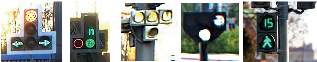
Рис. 6. Некоторые типы сигналов светофоров, распознаваемые классификатором
