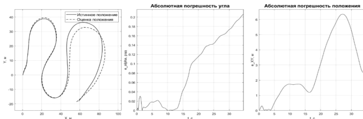
Рис. 2. Результаты моделирования алгоритма счисления пути на произвольной траектории
