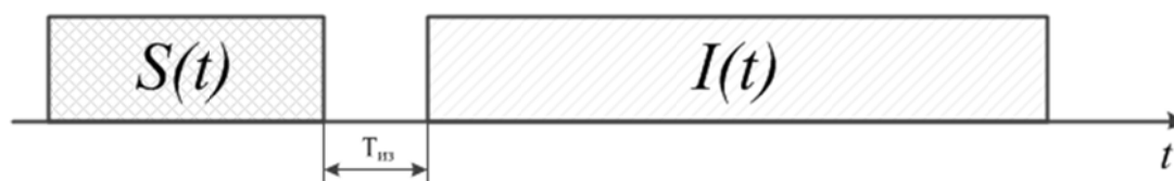
Рис. 1 – Структура связного сигнала АПС ЗПС
