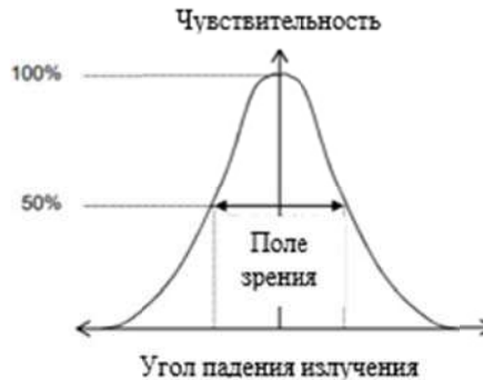
Рисунок 2. Вид зависимости чувствительности ИК-датчика от угла падения.
