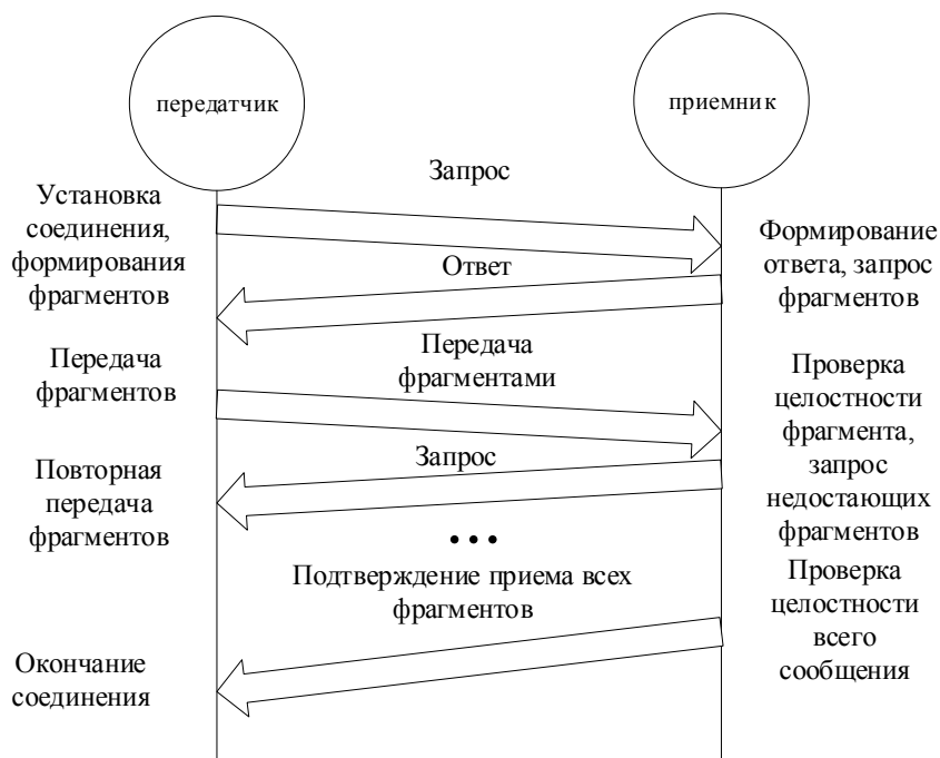
Рис. 2 – Алгоритм передачи сообщений макета АПС ЗПС
