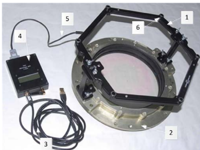
Рис. 2 Платформа приемников с блоком управления: 1 – платформа, размещенная вокруг иллюминатора, с ультразвуковыми приемниками; 2 – иллюминатор; 3 – кабель подключения блока управления к компьютеру экипажа; 4 - блок управления с Wi-Fi устройством связи; 5 - кабель подключения ультразвуковых приемников к блоку управления; 6 – ультразвуковой.
