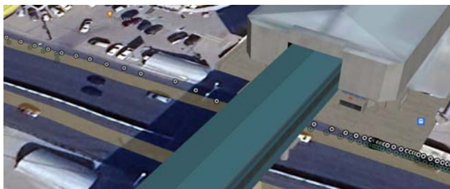
Рис. 3. Восстановление решения (Белая точка: коллаборативное позиционирование; Зеленая точка: эталонный трек из относительного метода)
