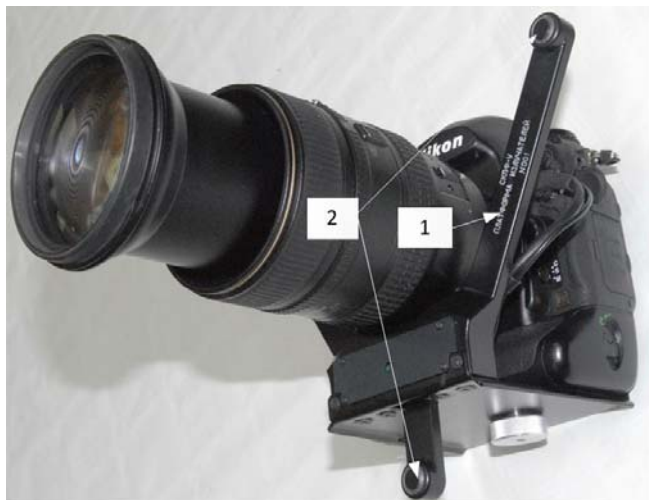
Рис. 1 Фотокамера с платформой излучателей: 1 – платформа, прикрепленная к фотокамере; 2 – ультразвуковые излучатели.
