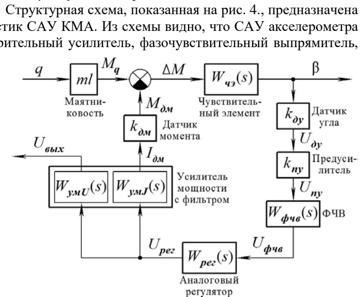
Рис. 4. Упрощенная структурная схема САУ КМА
