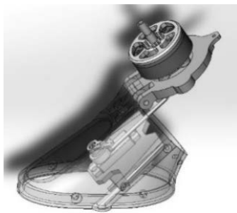
Рис. 2. Механизм поворота в открытом положении
