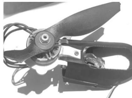
Рис. 4. Собранный узел поворотного механизма
