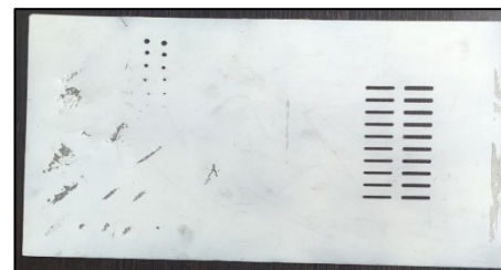
Рис. 2. Лист с дефектами для формирования обучающей выборки
