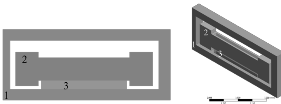
Рис. 1 – Конструктивная схема и размеры комбинированного МЭМС: 1 – рамка (стекло), 2 – чувствительная масса (стекло), 3 – подвес (эластомер)
