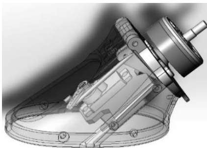
Рис. 3. Механизм поворота в закрытом положении
