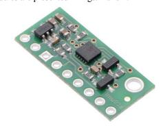
Fig. 1. MEMS board LSM6DS33 (10×23×3мм)
